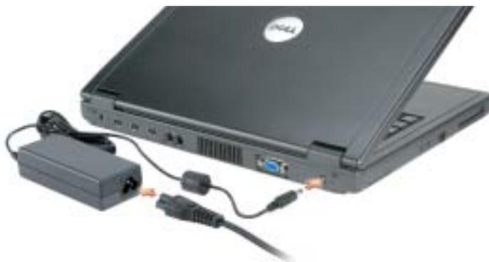
L'adattatore c.a. converte l'alimentazione c.a. in alimentazione c.c. richiesta dal computer. È possibile collegare l'adattatore c.a. quando il computer è acceso o spento.
