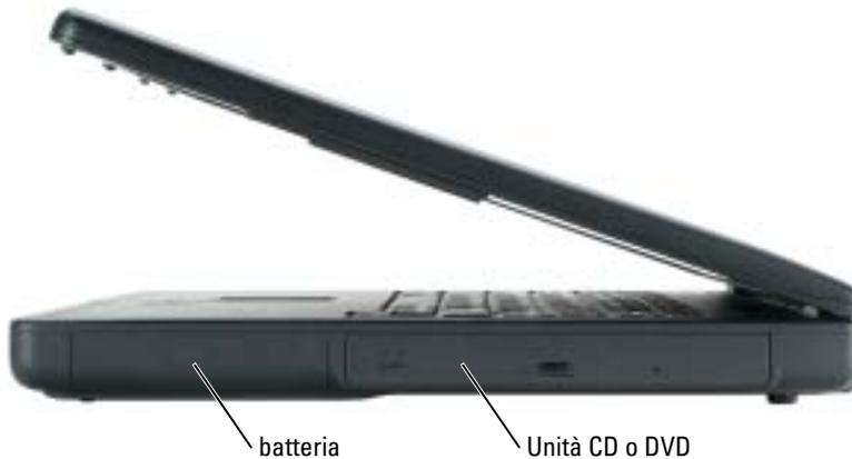
**BATTERIA/ALLOGGIAMENTO DELLA BATTERIA** — Se nell'alloggiamento è installata una batteria, è possibile usare il computer senza collegarlo a una presa elettrica. Consultare "Uso della batteria" a pagina 27.
