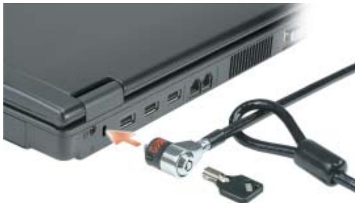
**SLOT PER CAVO DI SICUREZZA** — Consente di collegare al computer un dispositivo antifurto (reperibile in commercio). Per ulteriori informazioni, consultare le istruzioni fornite con il dispositivo.
