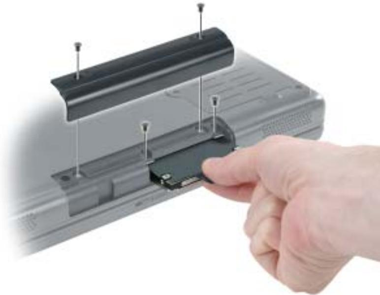
**AVVISO:** Quando il disco rigido non è inserito nel computer, riporlo in un involucro antistatico. Consultare la sezione "Protezione dalle scariche elettrostatiche" nella *Guida alle informazioni sul prodotto*.
